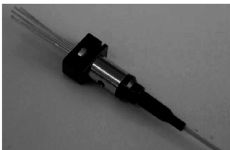
図3 光ファイバが接続された光通信用LDモジュール(同軸型モジュール, NEC製) 小型CAN-パッケージに実装されたLDに光ファイバを結合した汎用型光モジュール。広い温度範囲での使用が可能
